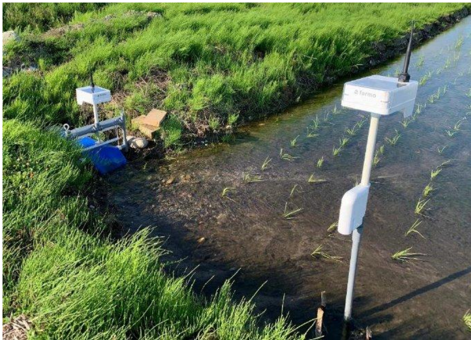
水位センサー(右)と給水ゲート
