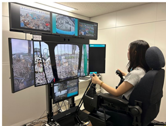
[遠隔操作システムから現場の重機を操作]
