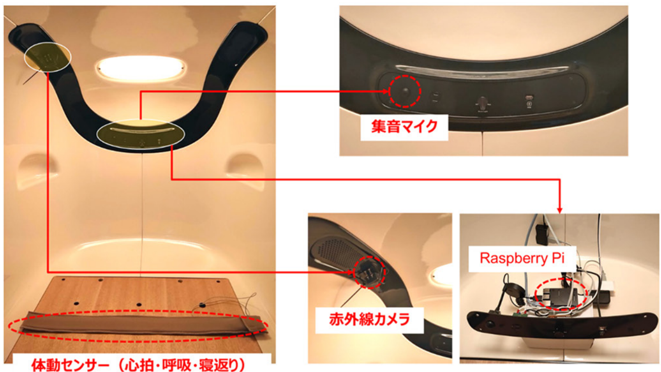
〔スリープテックホテルのカプセルユニットとセンサー〕
